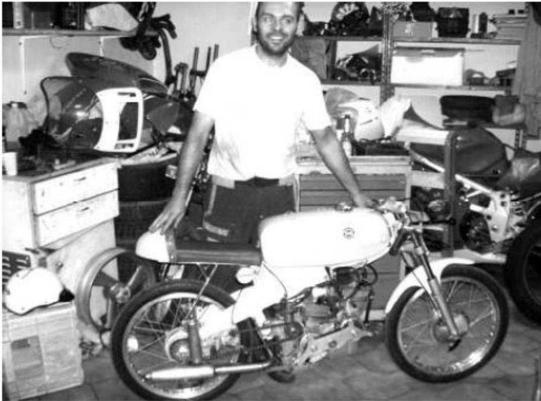
Scheda tecnica del Motom: E' stato utilizzato un telaio modello G.G. su cui inserire il motore bicilindrico. Molti dei pezzi utilizzati sono originali nel vero senso della parola, ossia di natura Motom o creati a mano dal costruttore. Il motore ha una posizione sfalsata per dare un'impronta più grintosa al mezzo ed il supporto motore del telaio è arretrato.
